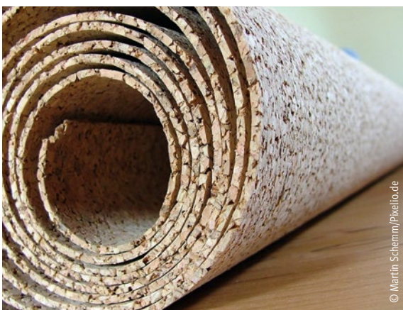
Eine Korksicht dämpft den Trittschall. Unter harten Böden wird sie flächig ausgelegt.
