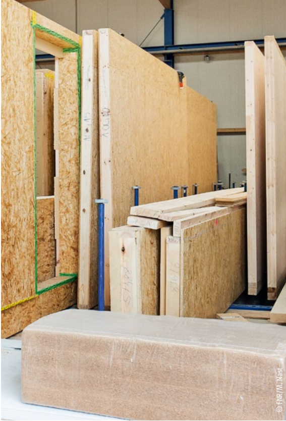
Vorgefertigte Wandelemente in der Werkstatt
