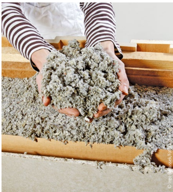
Zellulose als Dämmstoff
