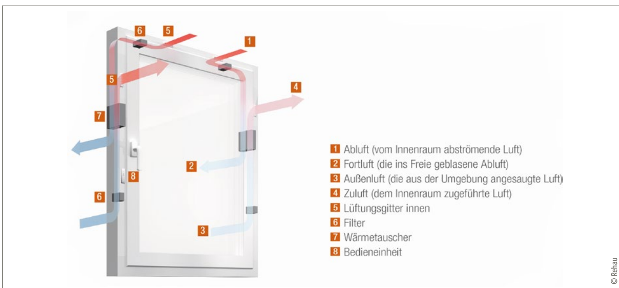
In Fensterrahmen integrierter Fensterlüfter mit Wärmerückgewinnung (Rehau)
