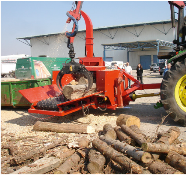
Abb. 2-8: Anbauhacker mit Kranbeschickung
