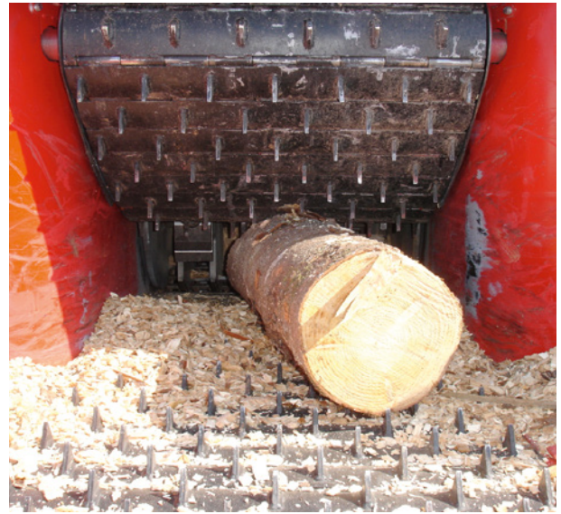
Abb. 2-9: Anbauhacker mit Kranbeschickung (Detail Einzug und Trommel)
