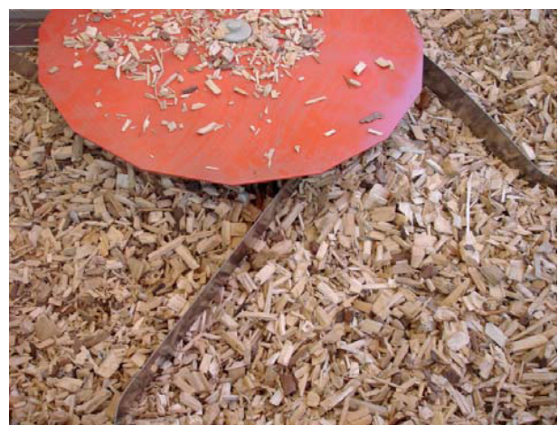
Abb. 3-4: Federzinkenaustragung im Hackschnitzelsilo
