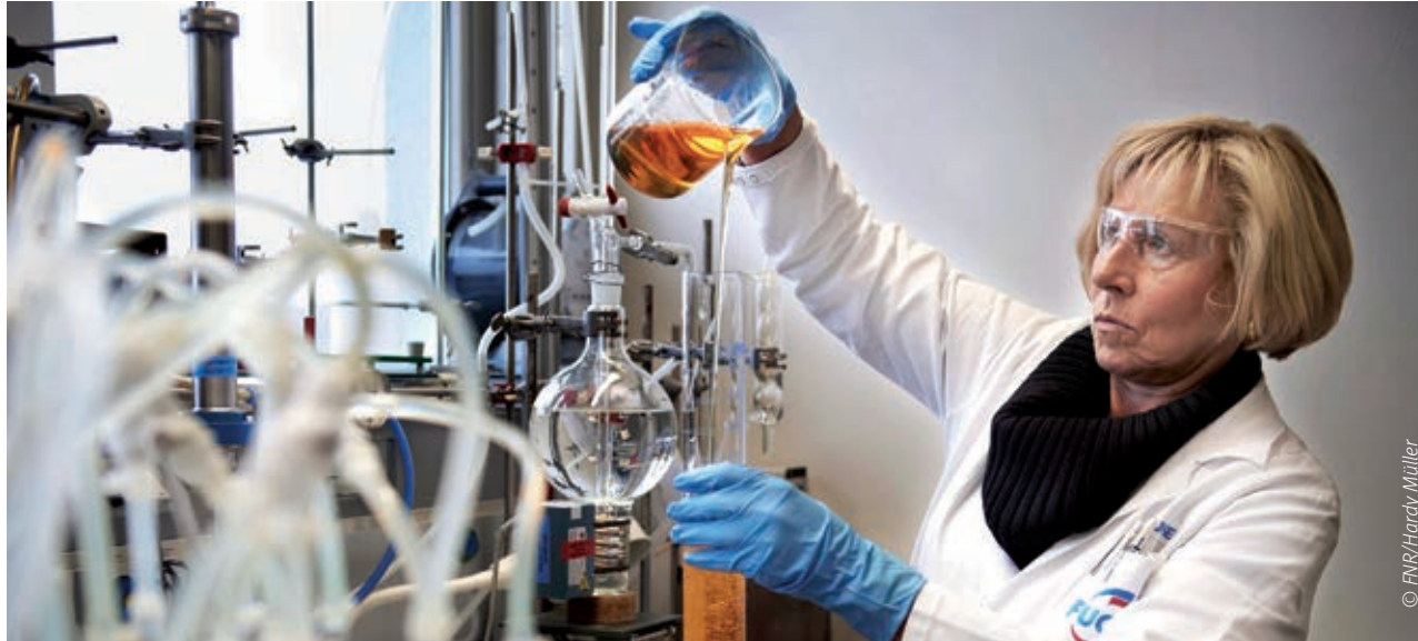
Tests zur Bestimmung der Alterungsstabilität von biobasiertem Schmieröl
