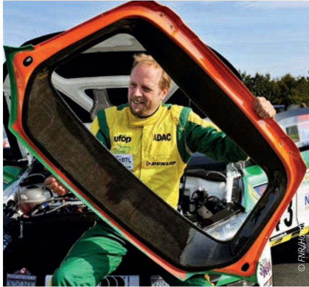
Die biobasierte Heckklappe des BioconceptCars besteht aus Flachfasern und Biokunststoffen
