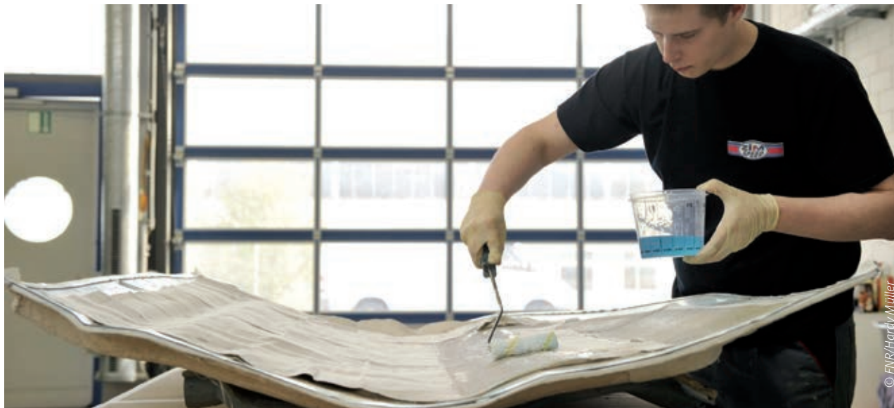
Karosserieteile des Rennwagens „BioconceptCar“ aus naturfaserverstärktem Biokunststoff in der Fertigung
