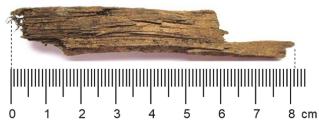
Abb. 4: Beispiel für die Bestimmung der Länge eines Holzhackschnittzels. Länge: 82 mm.
