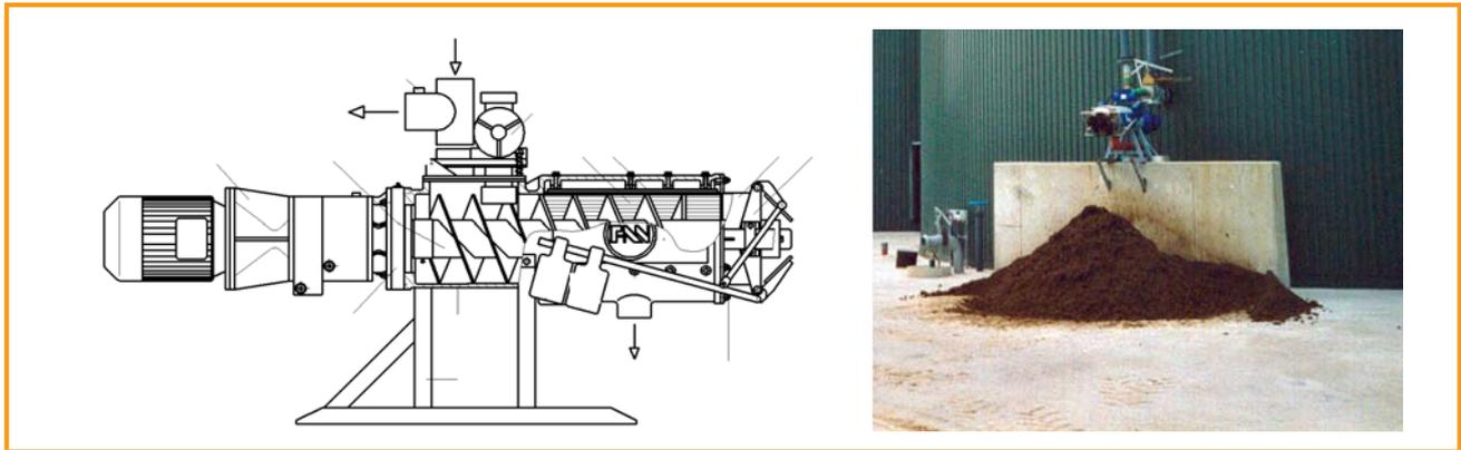
Figure 3.35: Screw separator [FAN Separator GmbH (left); PlanET Biogastechnik GmbH]
