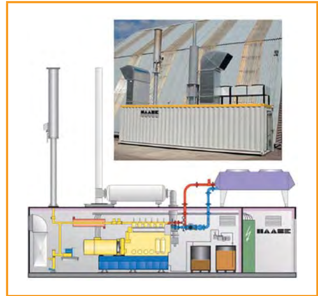
Şekil 6.5: Biyogaz kojenerasyon santrali, gaz yakma bacalı kompakt yapım tarzında komple modül [Haase Energietechnik AG]
