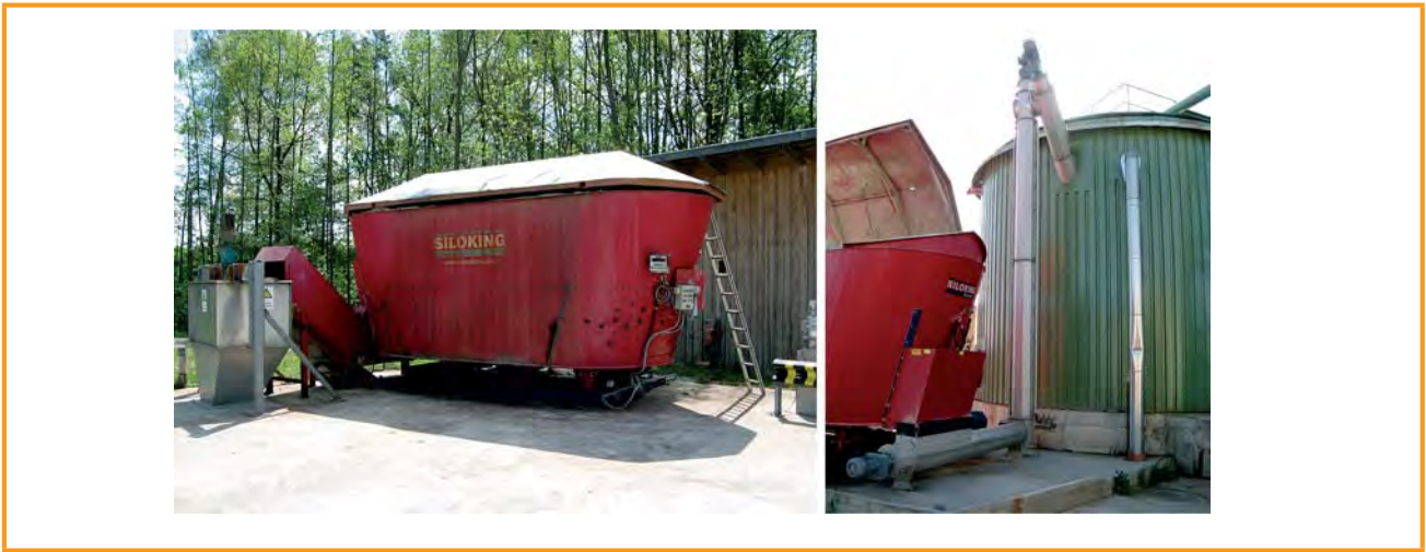
Şekil 3.19: İstiflenebilir biyokütlenin besleme helezonlarıyla yüklenmesi [DBFZ]
