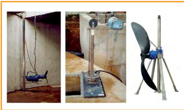
Şekil 3.31: Pervaneli DMK (solda), kılavuz borusu sistemi (ortada), büyük kanatlı DMK (sağda) [Agrartechnik Lothar Becker (solda, ortada), KSB AG]
