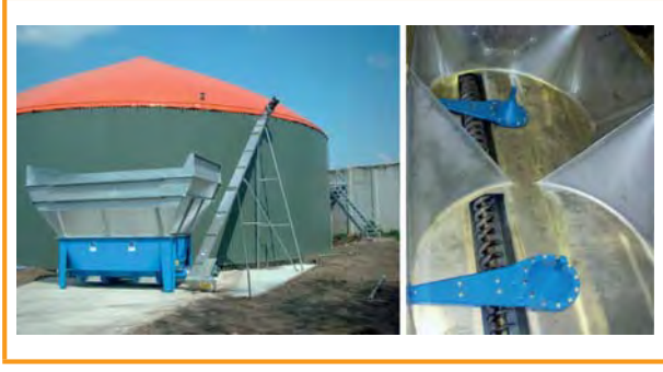
Şekil 3.6: Parçalama tertibatlı bir yükleme düzeneği [Konrad Pumpe GmbH]
