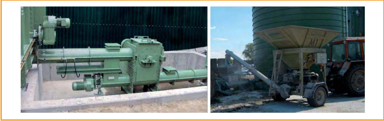
Şekil 3.7: Katı materyallerin parçalanması için çekiçli ve silindirik değirmenler [Huning Maschinenbau GmbH, DBFZ]
