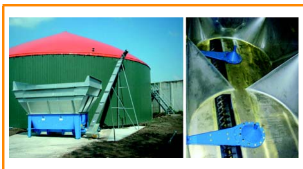
Figura 3.6: Receptor con aflojador [Konrad Pumpe GmbH]
