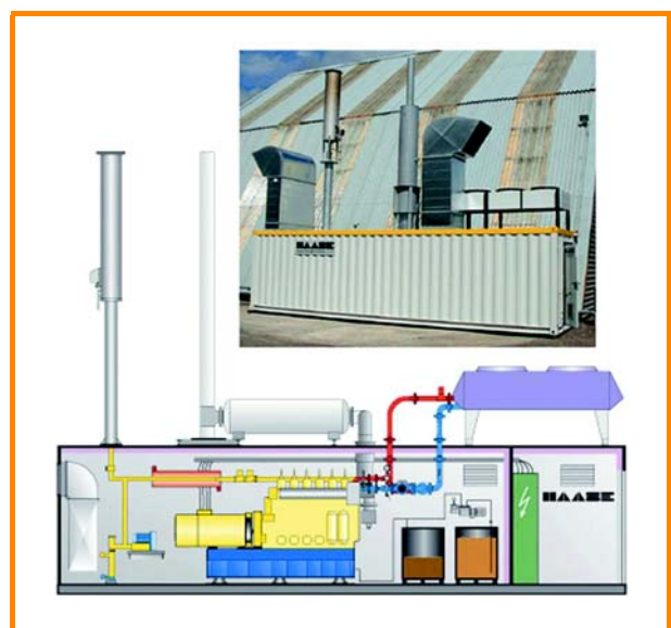
Figura 6.5: Unidad de CHP de biogás, módulo compacto independiente con bengala de emergencia [Haase Energietechnik AG]
