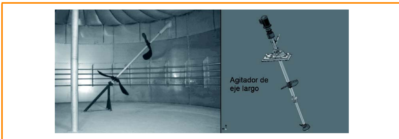
Figura 3.32: Agitadores de eje largo con dos cuchillas de agitación con y sin soporte del extremo del eje en el fondo del digestor [WELtec BioPower GmbH; gráfico: Armatec FTS-Armaturen GmbH & Co. KG]
