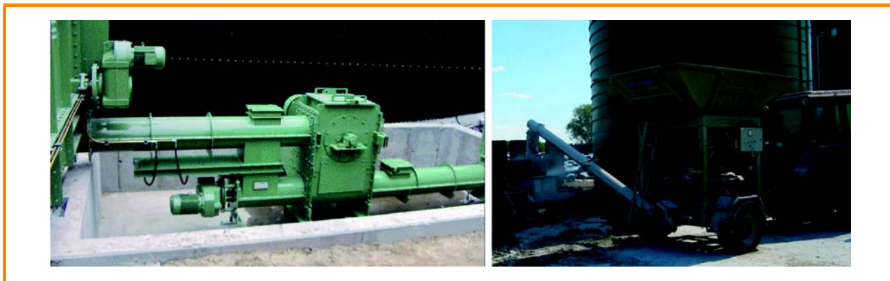
Figura 3.7: Molino batidor y molino de rodillo para el triturado de sustratos sólidos [Huning Maschinenbau GmbH, DBFZ]
