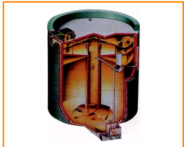
Figura 3.27: Digestor de dos cámaras [ENTEC Environment Technology Umwelttechnik GmbH]
