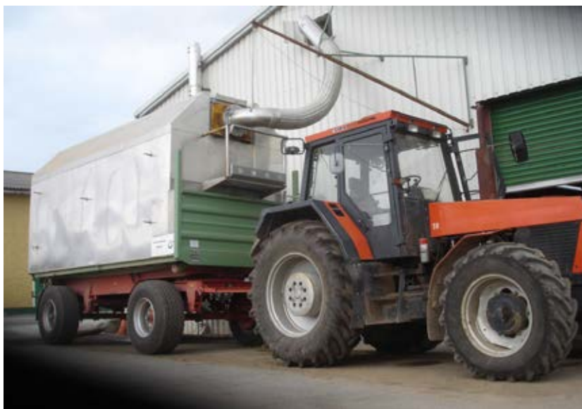
Abb. 10: Mobiler Container für die Destillation ätherischer Öle in der Agrargenossenschaft Hedersleben e.G.
