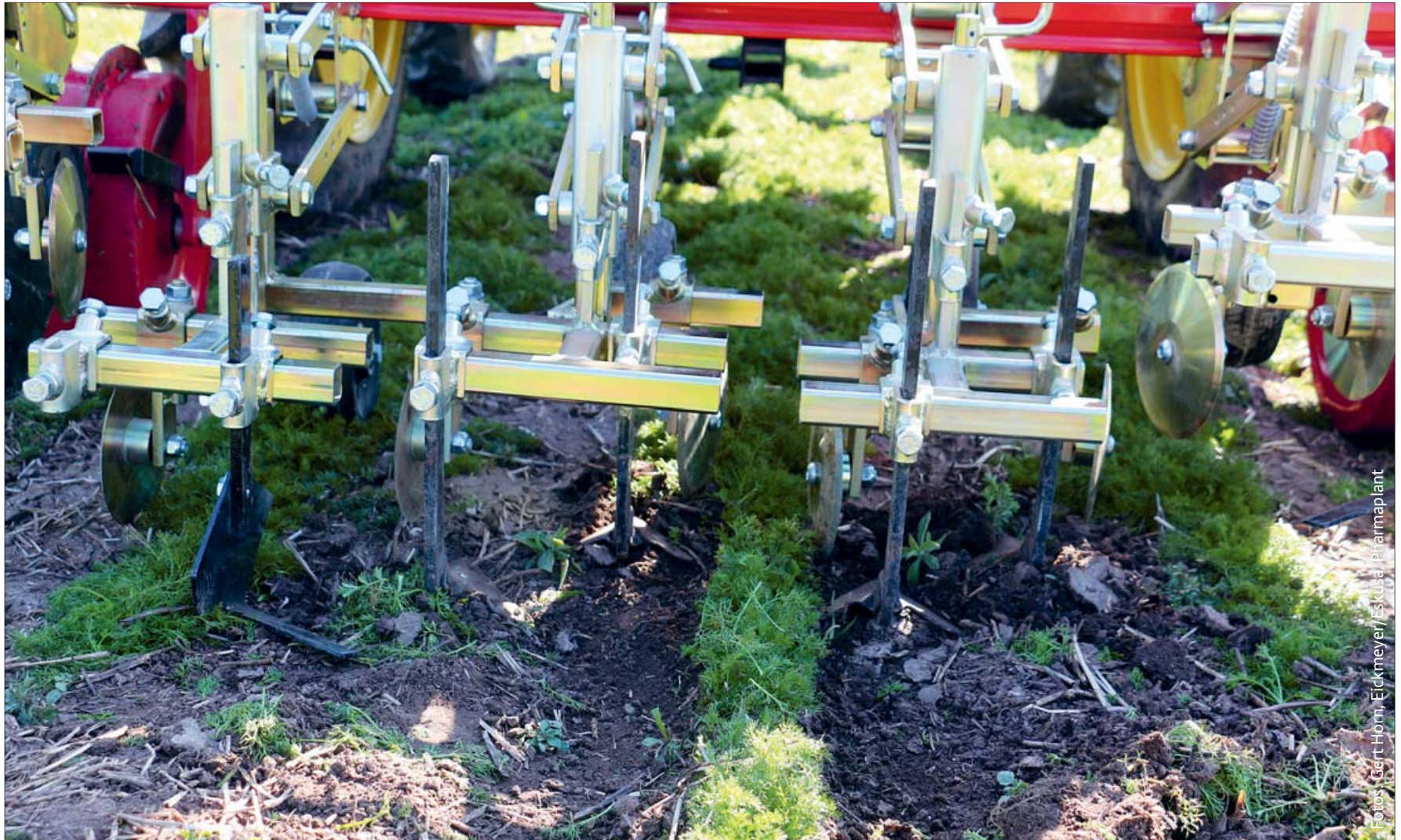
Bodenbearbeitung mit Gänsefußscharen in Kombination mit Winkelmessern.
