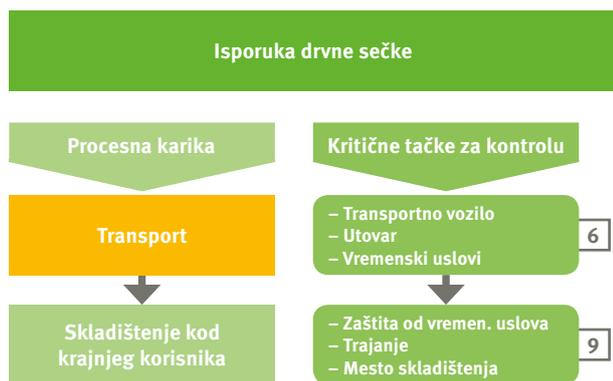
Slika 9.4: Opis procesa za isporuku drvene sečke (po uzoru na DIN EN 15234-4)
