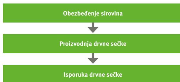
Slika 9.1: Struktura lanca isporuke drvne sečke u skladu sa DIN EN 15234-4
