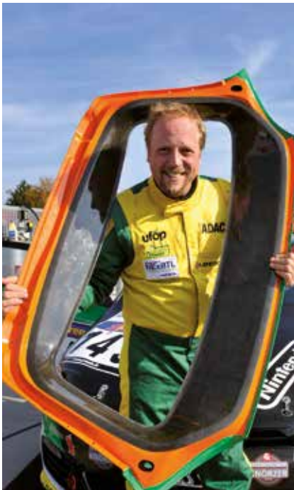
Bild 6.11: Heckklappe aus naturfaserverstärktem Kunststoff
