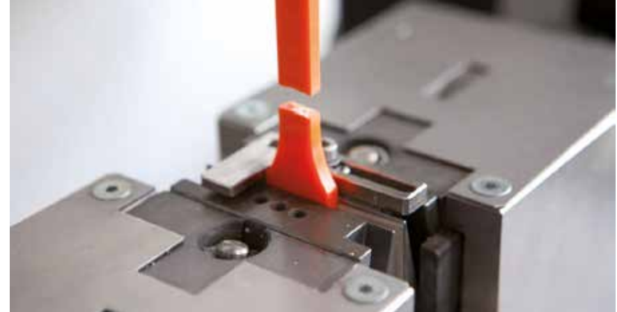
Bild 3.1: Biokunststoff-Prüfstab im Materialtest
