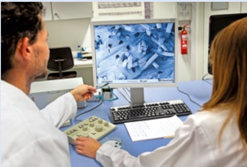
Die innere Struktur des Kompositmaterials wird durch das Rasterelektronenmikroskop sichtbar. Auf dem Bildschirm ist die 5.000-fach vergrößerte Bruchfläche eines mit Zellulosefaser verstärkten Polylactids zu sehen.
